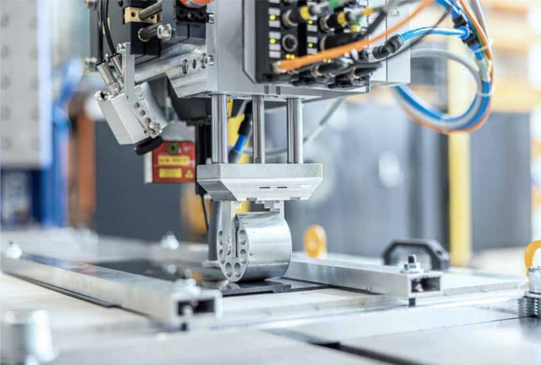
Induktionsschweißen von Thermoplasten soll die Verbindung von Composite-Teilen in Zukunft effizienter machen und weiter zur Gewichtsreduktion beitragen.
